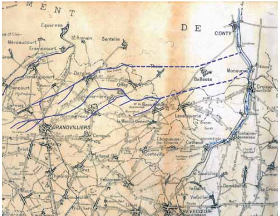
Les fossés humides, aujourd'hui disparus, assuraient l'écoulement et l'infiltration des eaux de pluie et de ruissellement. Ainsi, les eaux du secteur nord-ouest de Grandvilliers étaient acheminées vers la Selle qui les conduisait à la Somme (Carte IGN de 1954, source DDAF de l'Oise).
